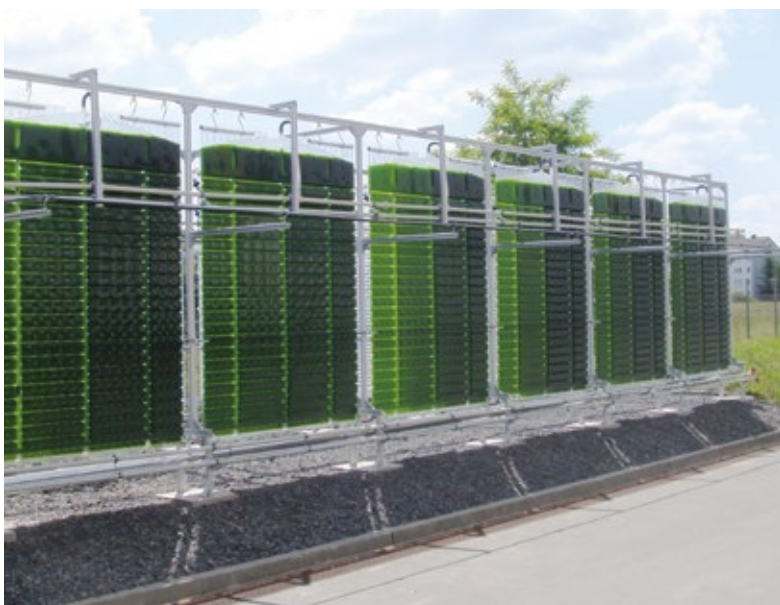
Kultivierungssystem für Algenbiomasse im Freiland. (Foto: Subitec GmbH)
