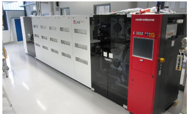
Neuer energiesparender Ofen an den DITF zur Stabilisierung der Vorläuferfasern von Carbonfasern im Teilvakuum. Foto: DITF
