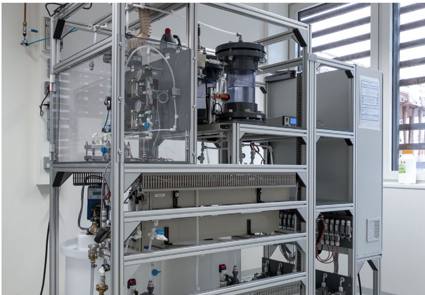
Die im CELBICON-Projekt am Fraunhofer IGB entwickelte Demonstrationsanlage synthetisiert Ameisensäure aus atmosphärischem CO 2 . Copyright: Fraunhofer IGB
