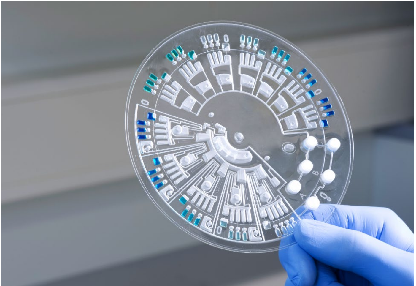
In einer mikrofluidischen Kunststoffdisk wird die Hautprobe vollautomatisch analysiert. Copyright: Dermagnostix GmbH
