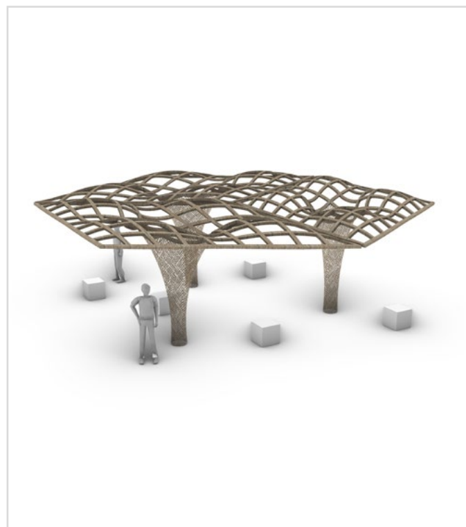
Der am KIT entwickelte Roboter spleißt die Weidenruten zu einem Endlosstrang zusammen und erstellt ein Bauteil mit Korbstruktur (links), Entwurf des Demonstrationsbaus mit Stützpfählen aus Flachfasern und einer Dachkonstruktion aus Holz für die BUGA 23 in Mannheim © KIT-DDF (links), KIT-DDF-FibR (rechts)
