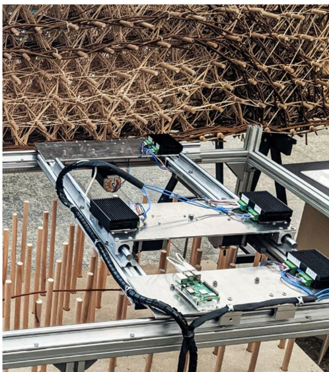
Der am KIT entwickelte Roboter spleißt die Weidenruten zu einem Endlosstrang zusammen und erstellt ein Bauteil mit Korbstruktur (links), Entwurf des Demonstrationsbaus mit Stützpfählen aus Flachfasern und einer Dachkonstruktion aus Holz für die BUGA 23 in Mannheim © KIT-DDF (links), KIT-DDF-FibR (rechts)
