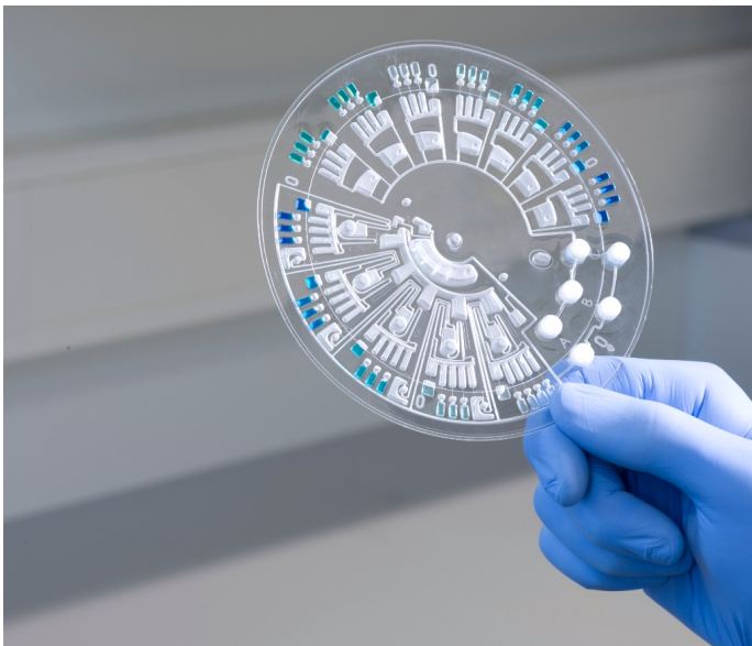
In einer mikrofluidischen Kunststoffdisk wird die Hautprobe vollautomatisch analysiert. © Dermagnostix GmbH
