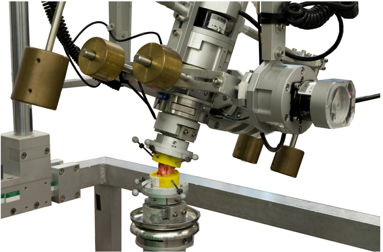
Auch langsame Bewegungen können mit dem Ulmer Simulator höchst genau analysiert werden. Dafür wird ein Kamerasystem mit Infrarot angeschlossen, dessen Sensoren auf Marker am Wirbelsäulenpräparat reagieren. Das System erlaubt kinematische Analysen mit einer Genauigkeit bis in den Zehn-Nanometer-Bereich.
