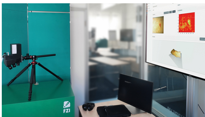
Im FZI House of Living Labs wurde ein Demonstrator des Diagnostik-Systems aufgebaut, bestehend aus Messsystem (links) und lokaler Recheneinheit für die Bedienung (rechts).
