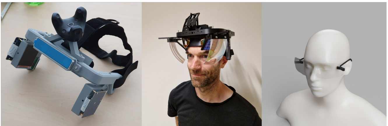
Links: Erstes Modell einer AR-Brille mit kleinen seitlichen Bildschirmen, um die bevorzugte Position der Einblendung zu testen. Mitte: Erweitertes Modell mit kleinen Bildschirmen sowie halbbreflektierenden Gläsern. Rechts: Zukunftsvision der AR-Brille © Aszländer, Universität Konstanz
